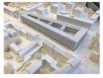
Der Entwurf sieht einen klar strukturierten, kompakten Baukörper mit einer offenen EG-Zone vor: Ein schwebender Baukörper auf einem Glassockel. Die Jury lobt den radikalen städtebaulichen Ansatz und die spürbare Großzügigkeit im Innenraum. Die Transparenz im EG und die Kompaktheit des gesamten Gebäudes tragen zur Einfügung im Stadtbild bei, die vier Höfe bilden eine großzügige Mitte. Negativ wird die geschlossene Fassadenfront an der Erne-Seder-Gasse gesehen.
