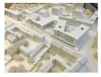
Der Entwurf sieht einen zweigeschossigen Sockel in Ziegeloptik vor. Darauf erhebt sich eine "Zickzack-Gebäudestruktur". Die Öffnungen (Gärten) ab dem 2. OG sind aus der Fußgängerperspektive nicht wirksam, da zu weit vom Straßenraum entfernt. Zudem sind die Öffnungen nicht schlüssig positioniert, da die Öffnungen zu beiden Straßenräumen gleich ausgeformt sind. Eine Reaktion auf die städtebaulich unterschiedlichen Situationen erfolgt nicht.
